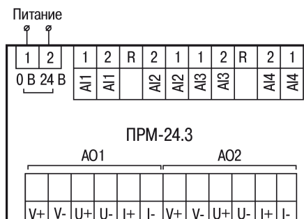
Рисунок 5.2 – Назначение контактов клеммника прибора с питанием 24 В
