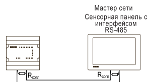
Рисунок 9 – Типовая схема подключения для ПР100 в режиме Slave
