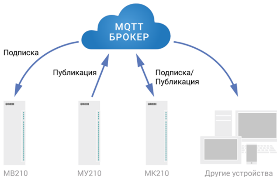
Рисунок 6.2 – Структурная схема обмена по протоколу MQTT
