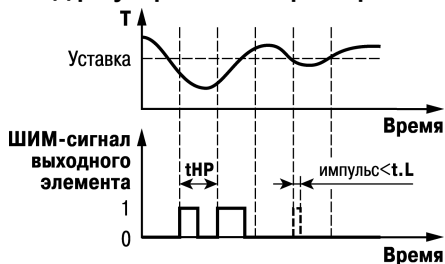
Рисунок 3.9 – Задание параметров ШИМ-сигнала
