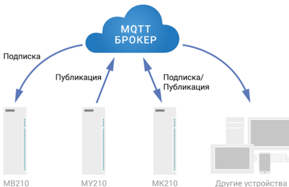
Рисунок 6.2 – Структурная схема обмена по протоколу MQTT
