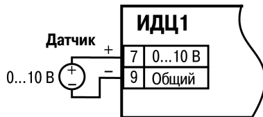
Рисунок 5.3 – Схема подключения к прибору датчика с сигналами постоянного напряжения от 0 до 1 В, от 0 до 10 В
