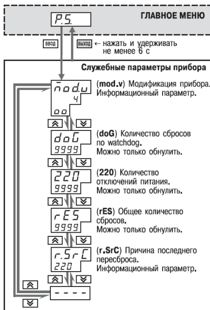
Рисунок 11.15 – Схема доступа к службным параметрам прибора
