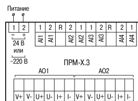
Рисунок 3 – Назначение контактов клеммника
