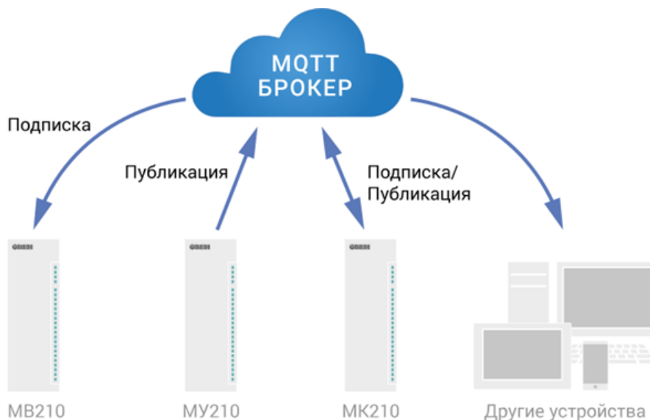
Рисунок 6.2 – Структурная схема обмена по протоколу MQTT
