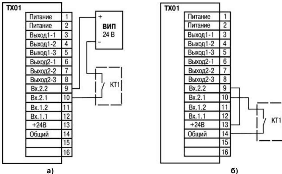
Рисунок Б.1 – Подключение к входу коммутационных устройств:
