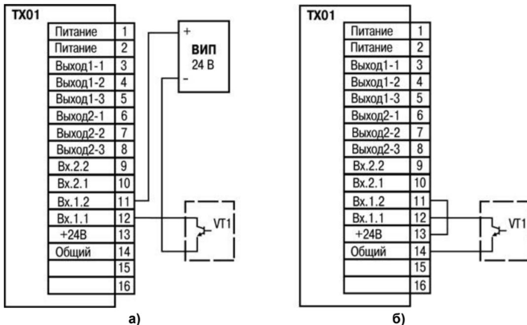
**Рисунок Б.2 – Подключение пассивных датчиков, имеющих на выходе транзистор *n-p-n* типа с открытым коллекторным входом:**
