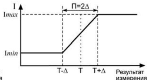
б) прямое пропорциональное регулирование
