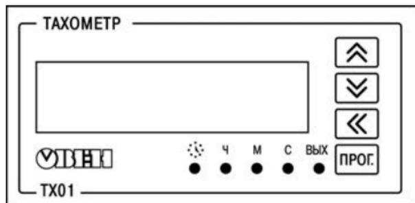
**Рисунок 3.3 – Внешний вид лицевой панели прибора для корпуса щитового (Щ2) крепления**
