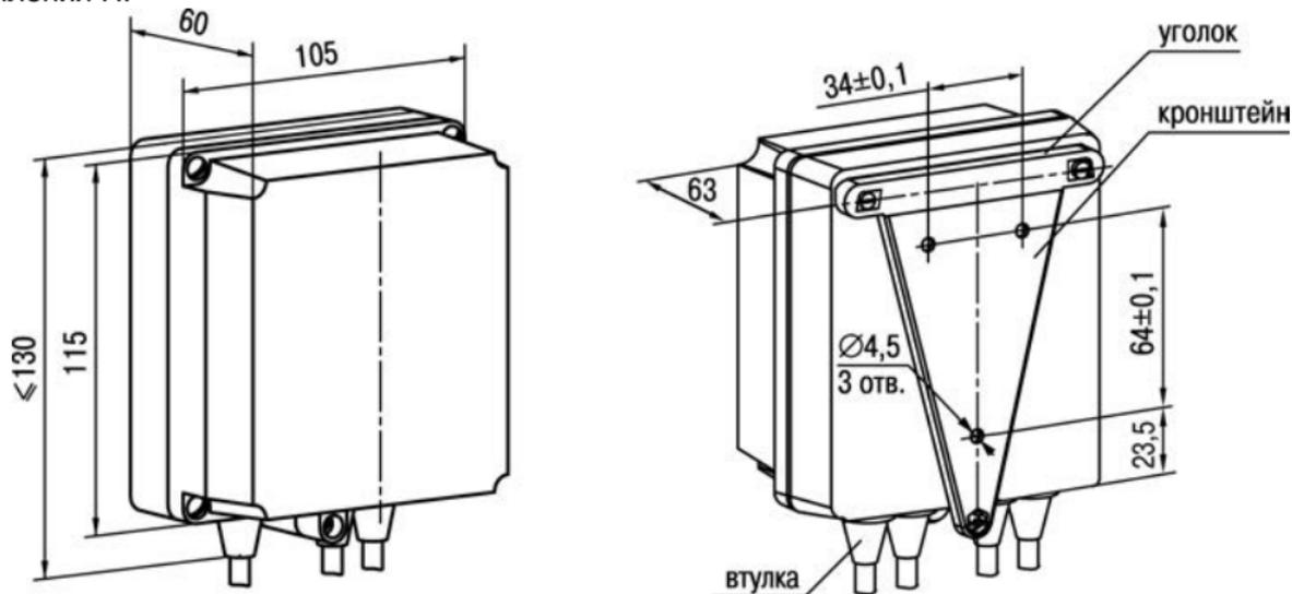
**Рисунок А.1 – Прибор настенного крепления Н**
