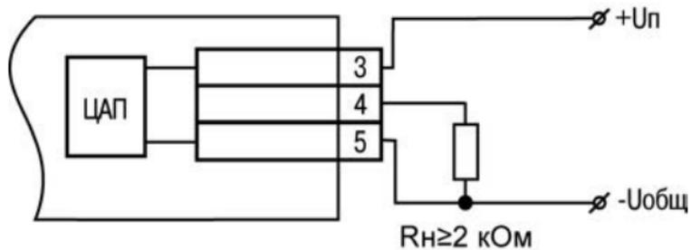
Рисунок Б.8 – Пример подключения ВУ типа У
