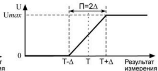
б) прямое пропорциональное регулирование
