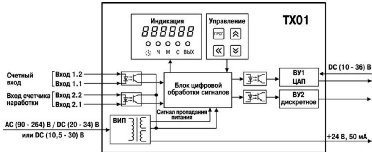
Рисунок 3.1 – Функциональная схема
