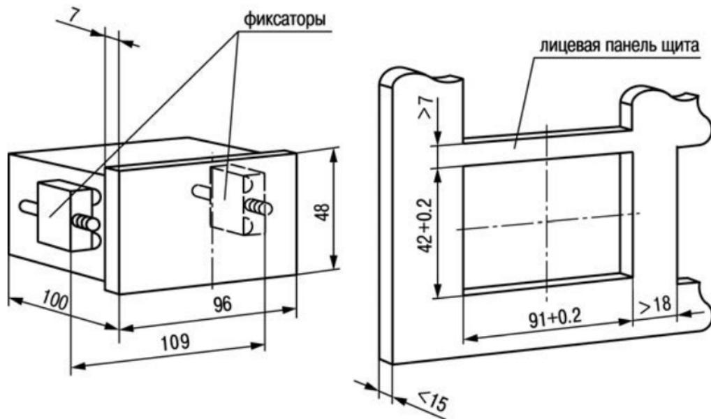
Рисунок А.2 – Прибор щитового крепления Щ2
