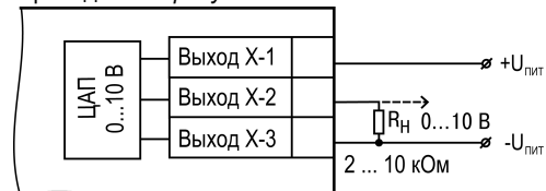
Рисунок 20 – Схема подключения нагрузки к ВУ типа У
