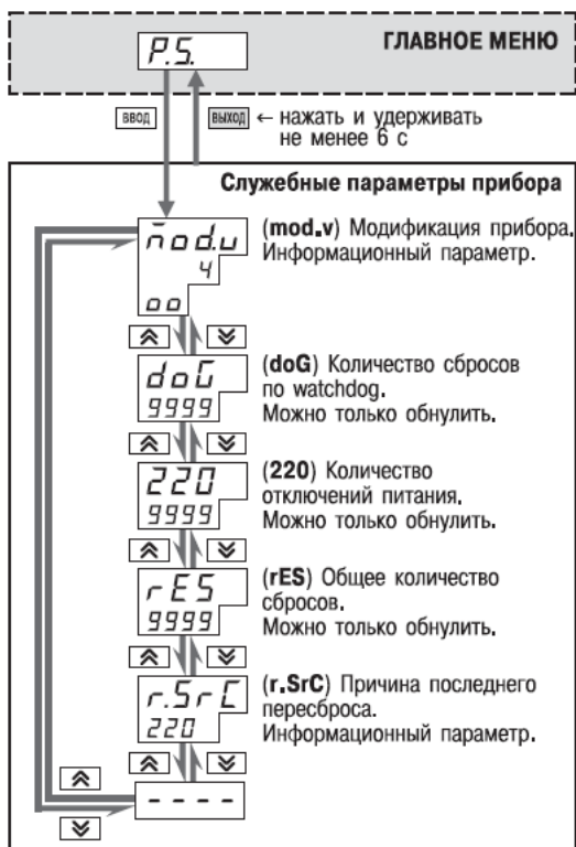
Рисунок 11.21 - Схема доступа к служебным параметрам прибора
