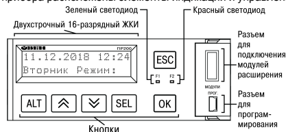
Рисунок 9 – Лицевая панель прибора (крышка отсека подключения модулей условно не показана)
