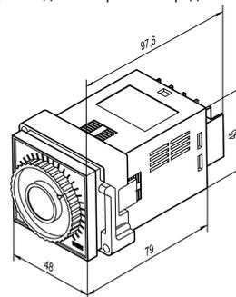
Рисунок 1 – Габаритные размеры
