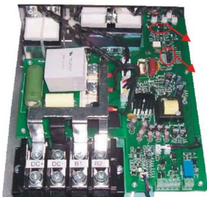
Клеммы питания DC+, DC- Клеммы подключения тормозного резистора B1, B2
